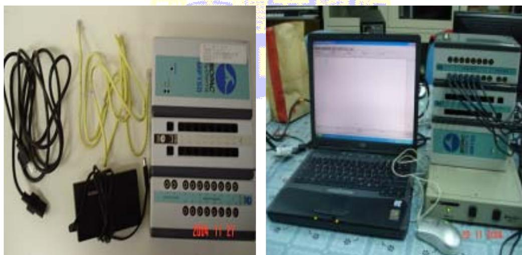
圖 4 MP150 訊號接收轉換器
